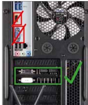
Bei verbauter Grafikkarte müssen deren Anschlüsse verwendet werden
